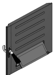
Рис. 3. Регулировочная дверца подачи первичного воздуха
