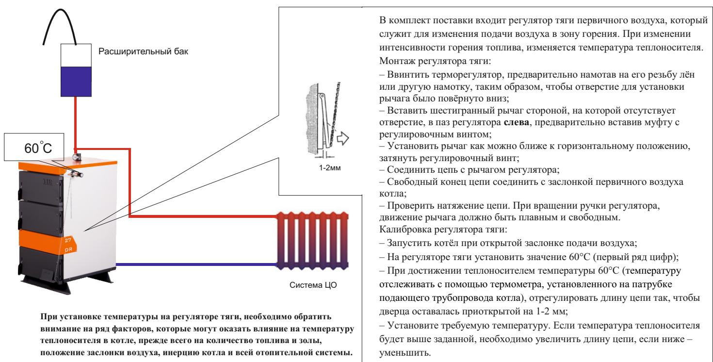
При установке температуры на регуляторе тяги, необходимо обратить внимание на ряд факторов, которые могут оказывать влияние на температуру теплоносителя в котле, прежде всего на количество топлива и золы, положение заслонки воздуха, инерцию котла и всей отопительной системы.
